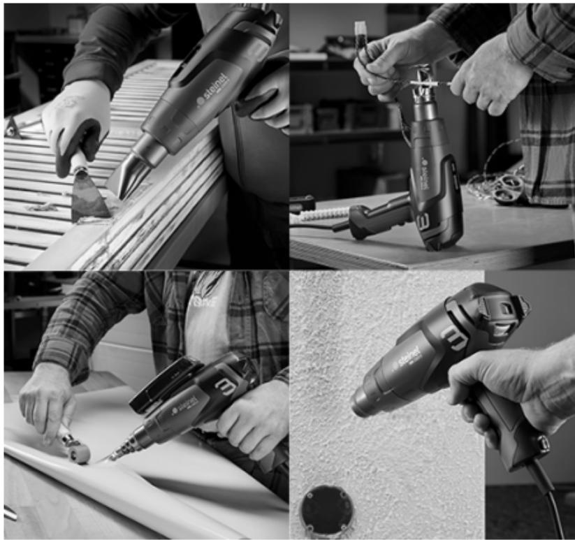
**Thermoformage du PVC :** qu'il s'agisse de plaques, de tubes ou de pièces moulées, l'air chaud ramollit le matériau et permet de le mettre en forme.
