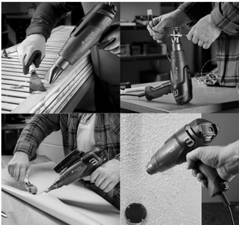
**Formning af PVC:** Plader, rør og formdele bliver bløde og kan formes med varmluft.
