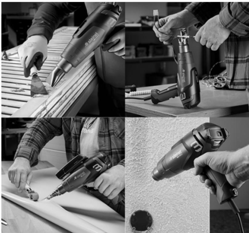
**Forme PVC:** Med varmluft blir plater, rør eller formdeler myke, slik at de lar seg forme.
