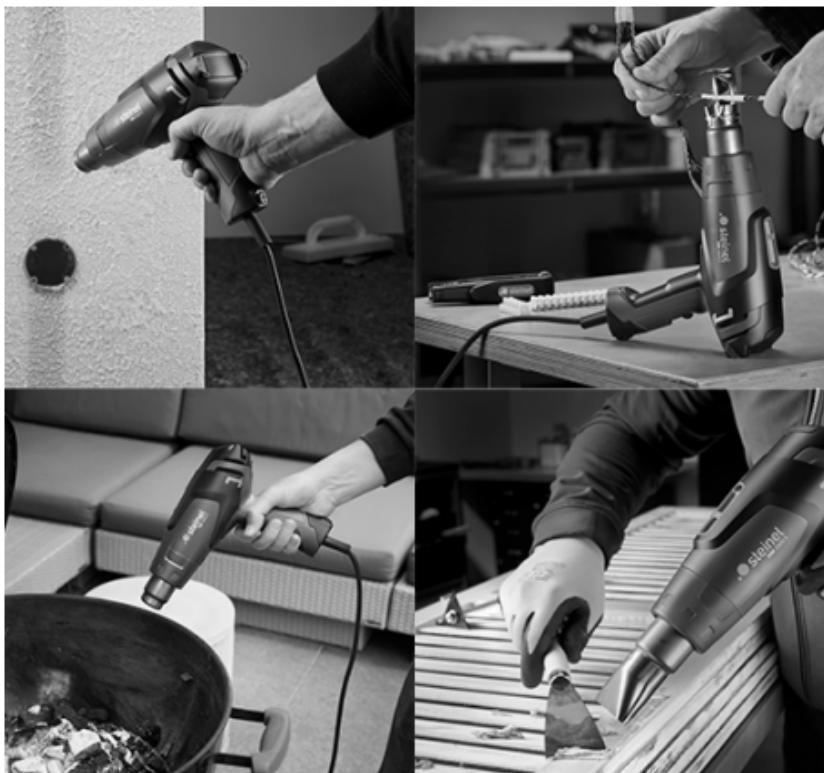
**Värvi eemaldamine:** Värv kuumutatakse pehmeks ja selle saab spaatli või kaabitsaga puhtalt eemaldada.
