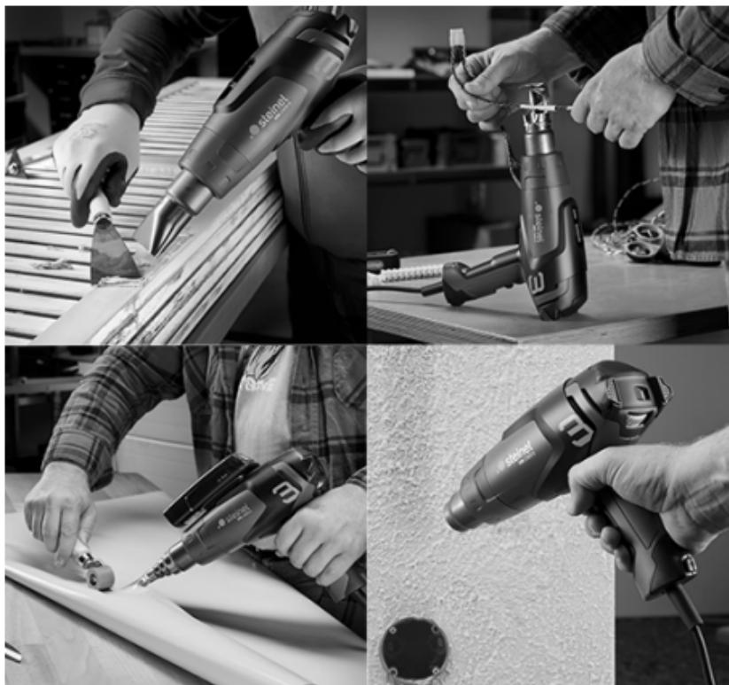
**PVC alakítás:** forró levegő hatására a lemezek, csövek vagy idomdarabok megpuhulnak és alakíthatóvá válnak.
