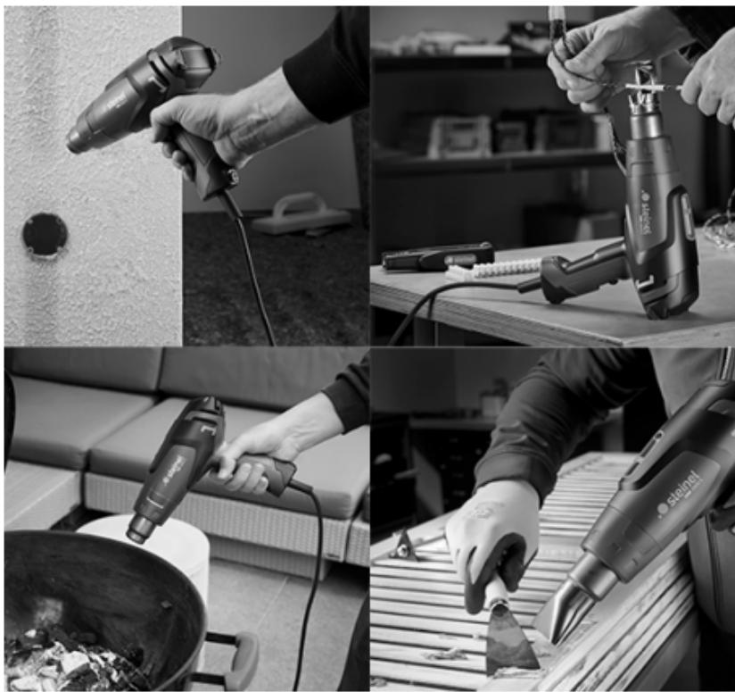
**去除油漆：**将油漆软化，然后用铲刀和刮刀去除干净。
