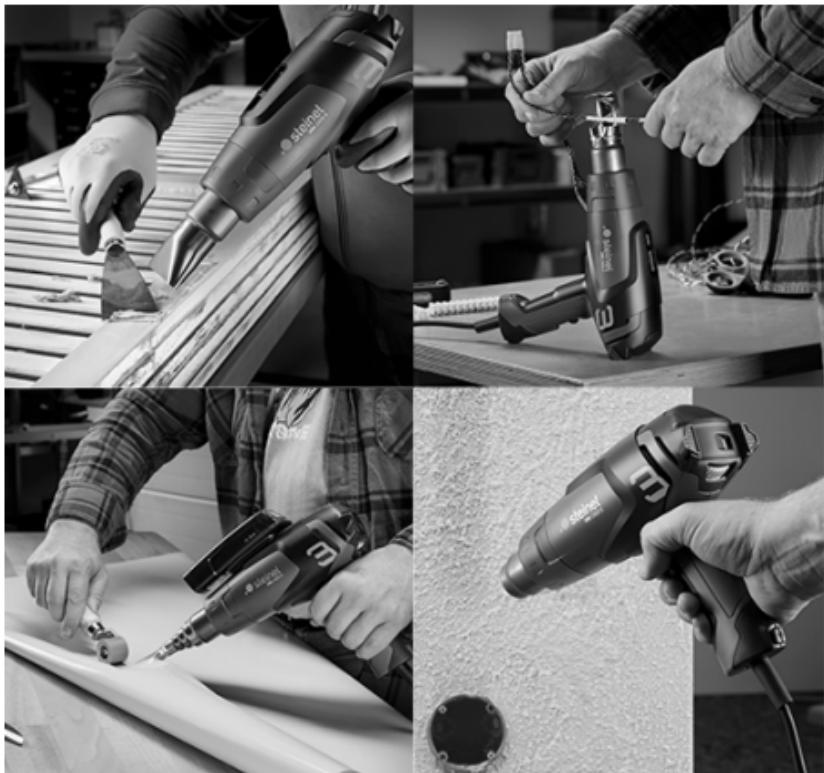
**PVC-Verformen:** Platten, Rohre oder Formteile werden durch Heißluft weich und formbar.
