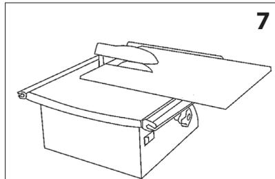
7. Utilisez la butée coulissante pour guider la pièce avec plus de précision et pour réaliser des coupes répétitives.
