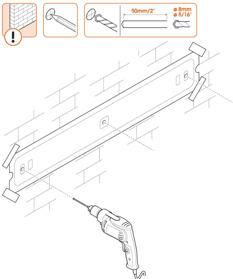
1. Trouvez l'endroit idéal pour le perçage avec notre application DrillRight™ AR et le gabarit de perçage inclus.
