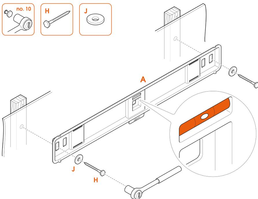
4. Fixez le support mural **A** au mur en bois à l'aide des vis **H** et des rondelles **J**. Utilisez le niveau à bulle pour niveler le support mural.
