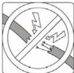
Auf beschädigte Drähte überprüfen
