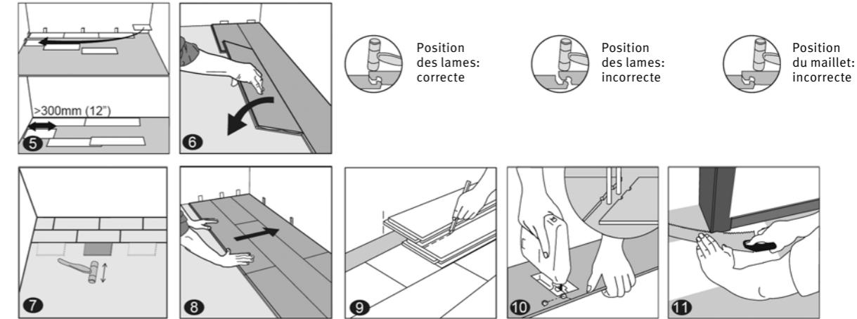
1. Une fois la sous-couche bien nettoyée, commencez la pose de gauche à droite. Placez la lame à 8 mm du mur de gauche. Utilisez des entretoises entre le mur et la lame.
