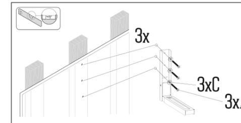
U kunt de schroeven die zijn meegeleverd met dit artikel gebruiken. De diepte van de gipsplaat en houten raggel mag niet minder dan 55mm zijn.
