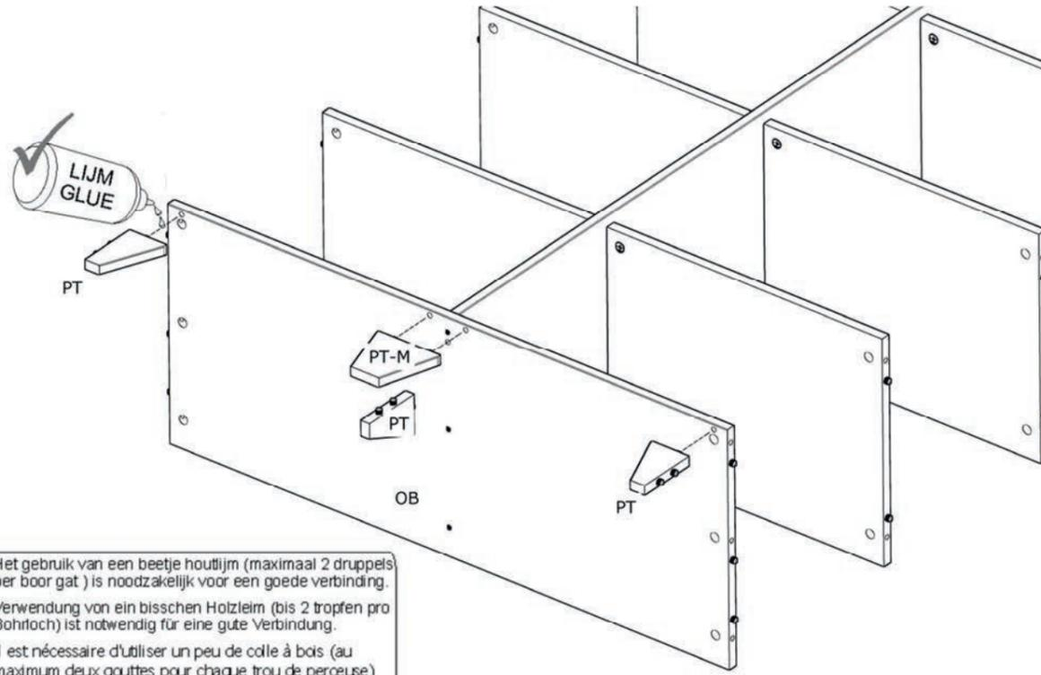
Het gebruik van een beetje houtlijm (maximaal 2 druppels per boor gat ) is noodzakelijk voor een goede verbinding.
