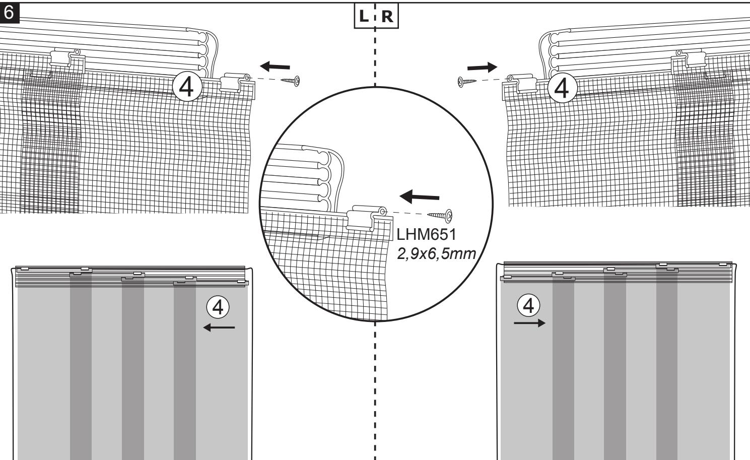
Monteer de schroef 2,9x6,5mm (LHM651) in het buitenste glijblok van de onderste gaaslamel, zodat deze niet verder in het bovenprofiel kan schuiven.
