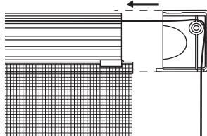
Plaats de eindkappen (LHM501/2) op de uiteinden van het bovenprofiel en leg het koord om het schroefkanaal van de eindkap.
