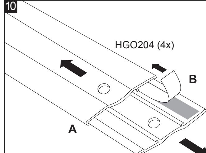
Demonteer de verzwaringsprofielen (HGO204) en verwijder het schutblad van de tape dat aan de binnenzijde is aangebracht.
